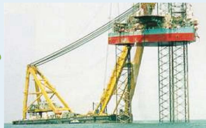
Кран-баржа с товароподемност 3200т (3200t Lifting Capacity Sheerleg Crane Vessel)
