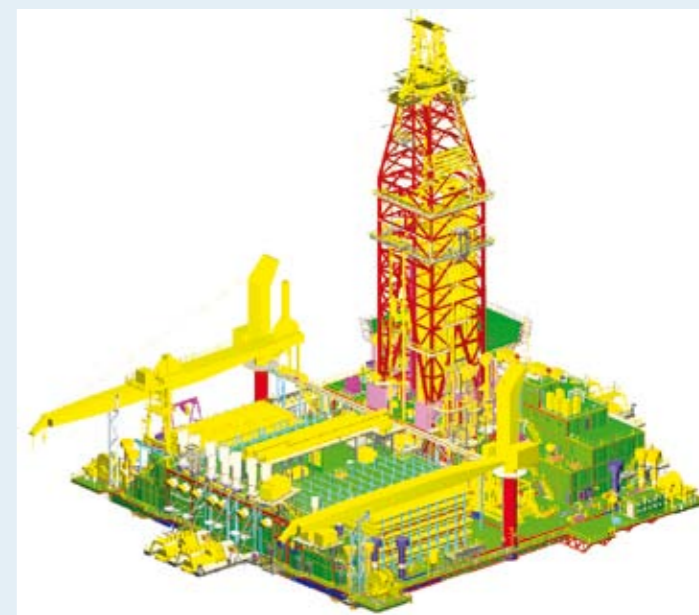
ENSCO 8500 Полупотопяема сондажна платформа, 2008/2009 (ENSCO 8500 Semi-submersible Drilling rig)
