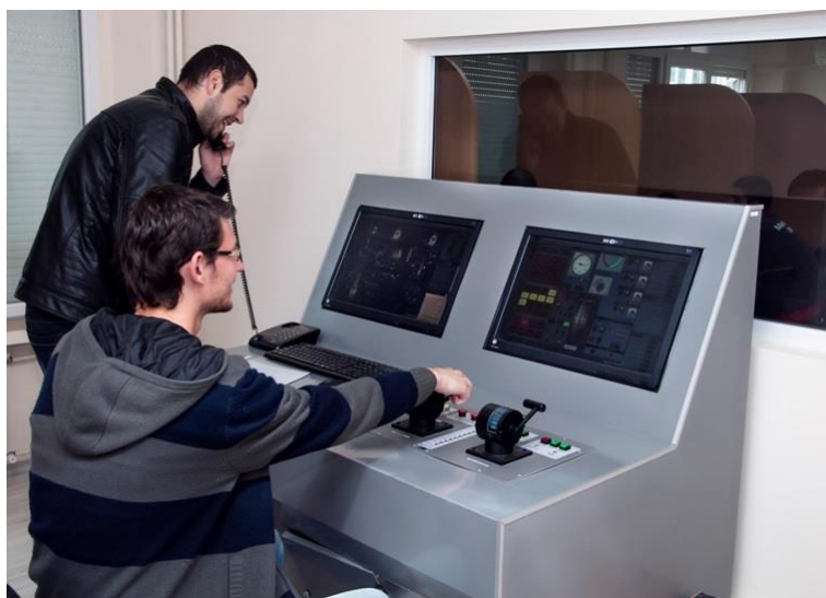
Тренажорен комплекс с Engine Room Simulator - работни места в залата за обучение и пулта на корабно машинно отделение
