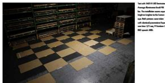
Тест с 160W LED прожектори. Средно ниво на осветеност 95 лукса.
